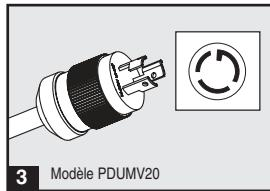
**5 Installation optionnelle (Modèle PDUMV20 Seulement).** La PDU comprend un adaptateur qui convertit la fiche d'entrée L5-20P en fiche d'entrée 5-20P. L'adaptateur est en option; la PDU fonctionnera correctement sans être connectée à l'adaptateur.
